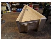
7. <u>Dachschrägen vorbohren (ca. 32mm vom Rand) und mit je 2 Schrauben (4x40) vorderes Dreieck festschrauben</u>
